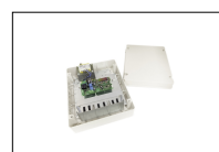
B71/PBX24/BOX Inverter ibrido versione "Network Assisted" per alimentazione dell'automazione con funzione di caricabatterie attraverso il collegamento ai pannelli solari o rete fissa per alimentazione dei controller digitali Brushless a 24V DC con tensione di rete a 230V AC.
