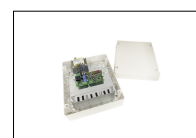
B71/PBX24/BOX/115 Inverter ibrido versione "Network Assisted" per alimentazione dell'automazione con funzione di caricabatterie attraverso il collegamento ai pannelli solari o rete fissa per alimentazione dei controller digitali Brushless a 24V DC con tensione di rete a 115V AC.
