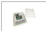
B71/PBX/BOX/115 Inverter ibrido versione "Network Assisted" per alimentazione dell'automazione con funzione di caricabatterie attraverso il collegamento ai pannelli solari o rete fissa per alimentazione dei controller digitali Brushless a 36V DC con tensione di rete a 115V AC.
